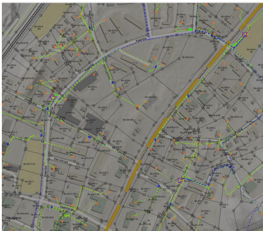
Kartalla on esitetty Carunan alueelle sijoittuva sähköverkko. Sinisellä viivalla on esitetty 20 kV johdot ja 0,4 kV johdot vihreällä. Ilmajohdot on esitetty yhtenäisellä viivalla, päällystetyt ilmajohdot pisteviivalla ja maakaapelit katkoviivalla.
